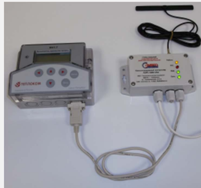
Шаг 3. Подключить прибор учета. Включить питание
